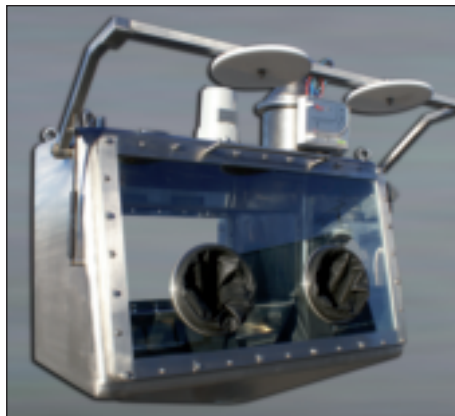
Isolatore statico per lo scarico da filtro essiccatore Static glove box for filter dryer discharge
