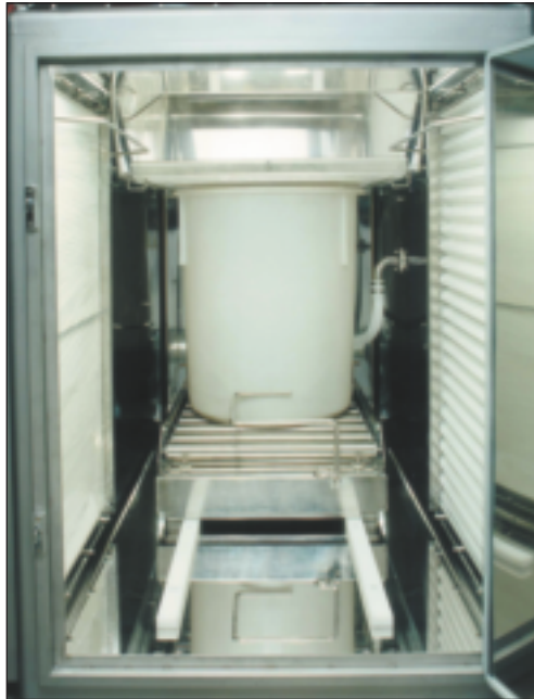
Stazione di scarico per centrifughe e filtri essiccatori (interno) Centrifuges and dryer filters discharging Box (inside view)
