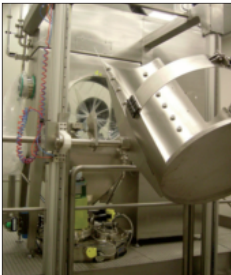
Isolatore con dispositivo di carico/scarico materia prima a "liner continuo" Glove Box with charging/discharging device of raw material to "continuous liner"
