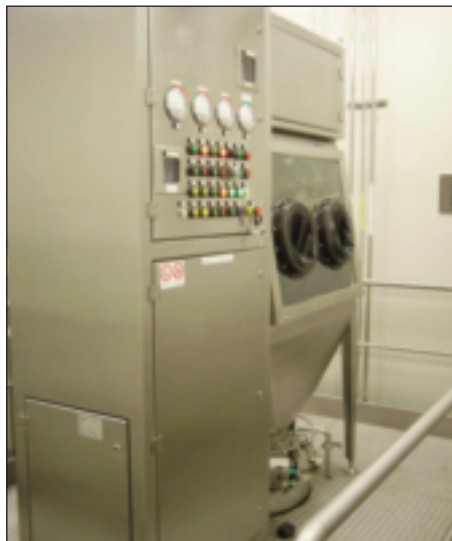
Isolatore con riciclo di gas inerte ad alto contenimento Glove Box with high containment inert gas recycle
