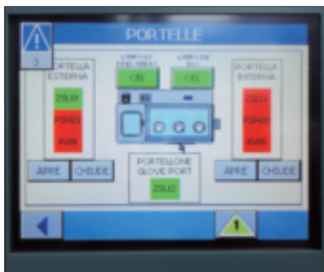
Esempio di sinottico su touch panel Example of synoptic display on touch panel
