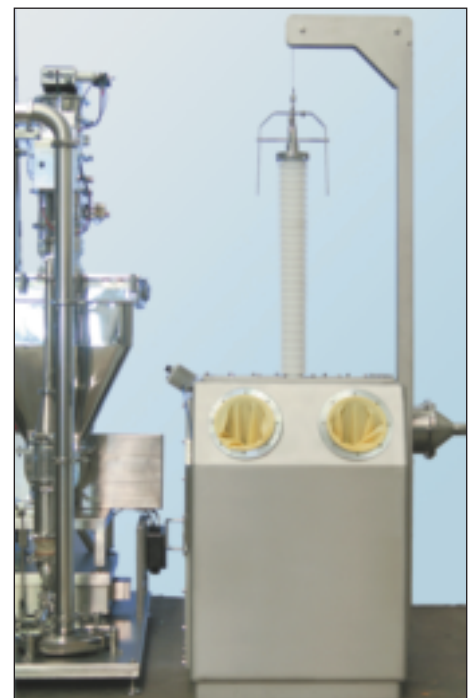
Stazione per lo svuotamento fusti mediante sonda di aspirazione Drum emptying Glove Box by suction probe
