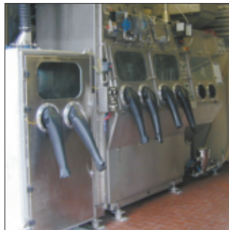
Stazione di ribaltamento fusti con pre-camera (esterno) Drum overturning Glove Box with pre-chamber (outside view)
