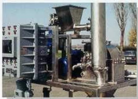
L'accesso alla griglia ed agli organi interni del mulino è reso agevole grazie alla realizzazione del corpo in due metà, incernierate fra loro, facilmente apribili ed ispezionabili. Particolare, quest'ultimo, di fondamentale importanza qualora sia necessario eseguire frequenti ed accurate pulizie o bonifiche per esigenze produttive.
