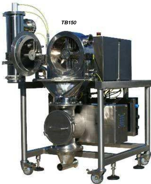
Il nuovo mulino "TURBINE" è in grado di raggiungere finezze anche inferiori a 100 µm e, disponibile in tre diversi modelli, permette di trattare quantitativi che a partire da 0,1 kg/h della versione da laboratorio possono raggiungere anche 2000 kg/h con il modello più grande.
