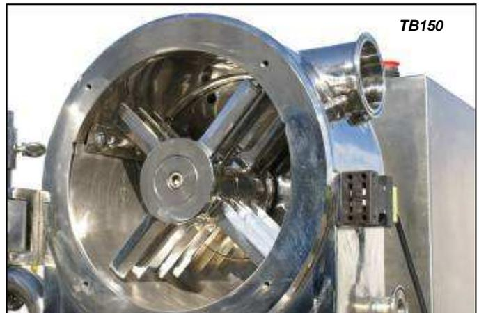
Tutte le parti interne del mulino a contatto con il prodotto sono realizzate in acciaio inox AISI 316 L e lucidate specularmente per consentire radicali operazioni di bonifica.
