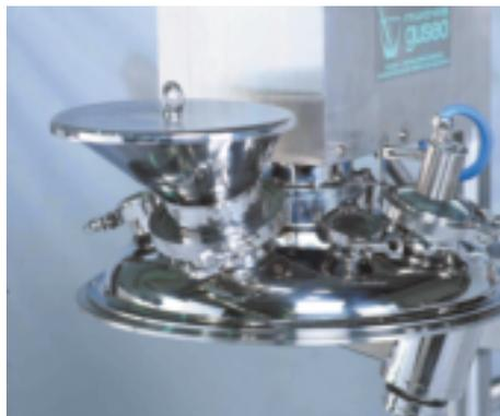
Inoltre, la forma conica della vasca di mescola permette di avere una velocità di movimento delle particelle diversa in relazione alla loro posizione rispetto al fondo dove le particelle si muovono più velocemente.
